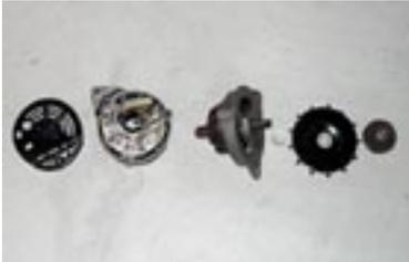
Teilung der Lichtmaschine: Zur weiteren Zerlegung die 3 Schrauben die Vorder- und Rückhälfte zusammenhalten Herausschrauben. Nun lässt sich die Lichtmaschine teilen vorderer- hinterer Stator und der Rotor.
